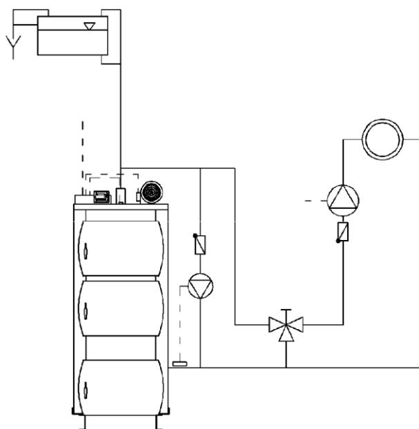
Подключение с 3-х ходовым клапаном и водонагревателем
